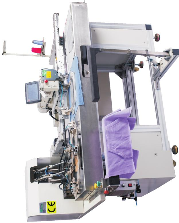
采用缝料直驱系列 4025 机头，全自动免烫贴袋机，适用于中厚料产品的外贴袋，专用于针织卫衣的前袋鼠袋制做以及针织后背贴工艺；
