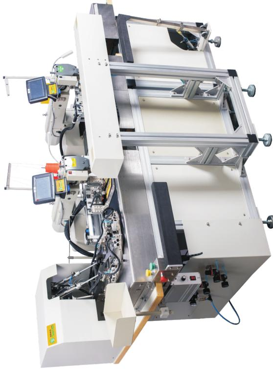
采用缝科直驱系列3020机头，全自动免烫贴袋机，适用于中厚料产品的外贴袋，包括：牛仔面料，斜纹面料等等。
