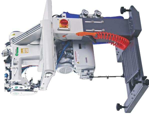
自动抬压脚, 气动抬推轮, 自动机针冷却, 自动剪线装置, 线头吸入式;
